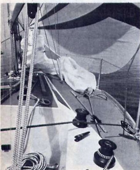
Sopra: vista del pozzetto da poppa; il trasto mobile della scotta della randa scorre su un binario fissato su una barra a tutta lunghezza, che separa non solo idealmente l'estrema zona poppiera riservata al timoniere da quella per i «passaggeri». Sotto a sinistra, in primo piano la scotta della randa e, sulla destra, i rinvii per lo spi; al centro, la scotta del fiocco con relativi binario, winch e galloccia; a destra, infine, la zona bassa dell'albero con l'attacco del boma, winch, trasto per spi ed attacco del vang.
